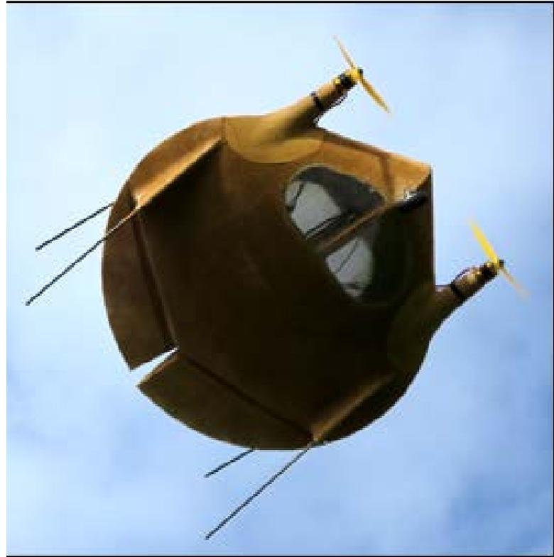
Oloidflugzeug im Flug (neuestes, ferngesteuertes Modell. Man sieht die unten liegenden Fenster für den liegenden Piloten und Passagier).
